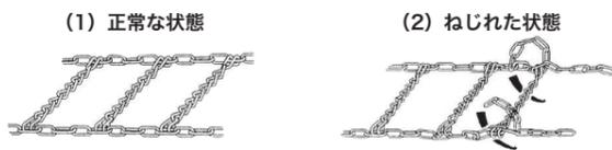
☆ねじれたまま装着走行しますと、早期折損、タイヤ損傷の原因となります。
